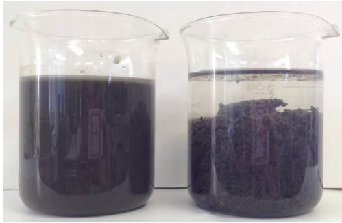
図1 凝集沈殿試験結果
